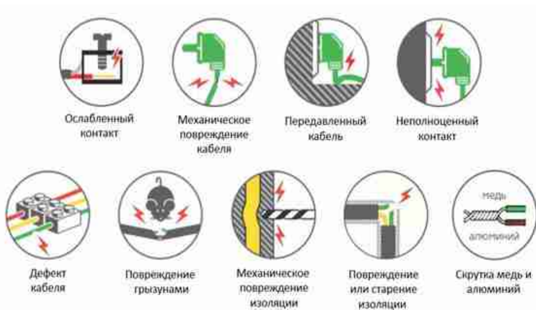
Рисунок 6. Возможные причины искрения в электропроводке
